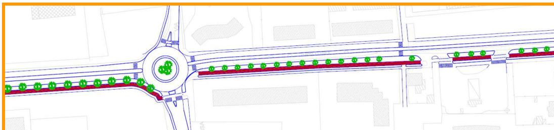
In uscita da via Carducci si propone l'impedimento delle svolte a sinistra, mentre le intersezioni con via Pisa e via Parma vengono regolate da rotonda (diametro indicativo rispettivamente di 34 m e 40 m).
