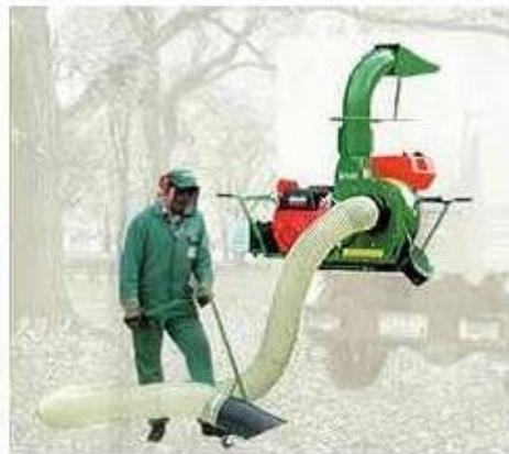
re di rimorchi o autocarri, permette la raccolta dei residui dello sfalcio, mediante aspirazione dal suolo con tubo flessibile e bocchetta aspirante. Il prodotto così aspirato verranno caricati sul cassone dell'automezzo.
