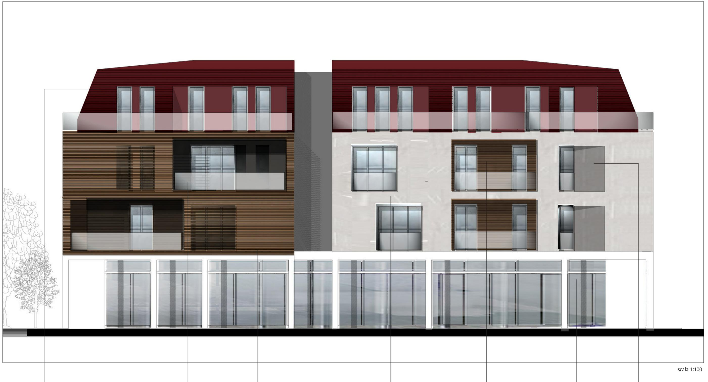
rivestimento ceramico opaco in lastre di grande formato con fresature orizzontali. colore NCS S 6030-R20B (come klinker grattacielo)
